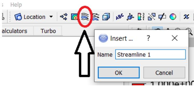
Нажимаем на иконку Streamlines, нажимаем ОК. Настраиваем в появившемся меню Streamlines все следующим образом, как показано на рисунке.
