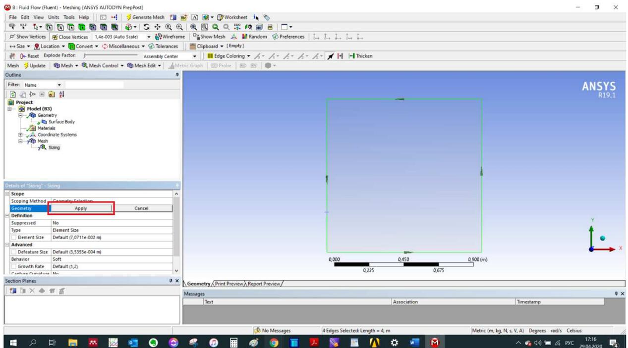
ANSYS позволяет настраивать размеры сетки разными способами. По умолчанию в настройках появится Element Sizing, который задает единый размер для всех ячеек выбранной геометрии. Однако, нам необходимо задать размер с помощью деления ребер на отрезки, поэтому в Type мы поменяем настройки на Number of Divisions и настроим необходимое количество.
