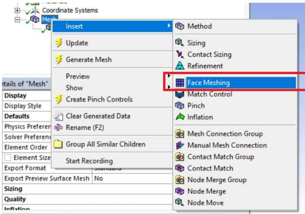
Выбираем всю плоскость и нажимаем Apply. В итоге получим следующую структурированную сетку, сгущенную в пристеночных областях.
