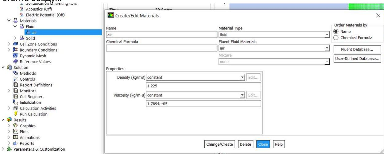
Так как для нашей задачи необходимо рассчитать течение с числом Рейнольдса  $Re=1000$ , «создадим» свою жидкость с нужными нам свойствами. Переименуем air в fluid, плотность зададим равной  $1 \text{ kg/m}^3$ , динамическую вязкость зададим равной  $0,001 \text{ kg/(m*s)}$ . Учитывая, что характеристическая длина равна 1 метру, скорость течения 1 м/с, получим желаемое число Рейнольдса  $Re=1000$ .
